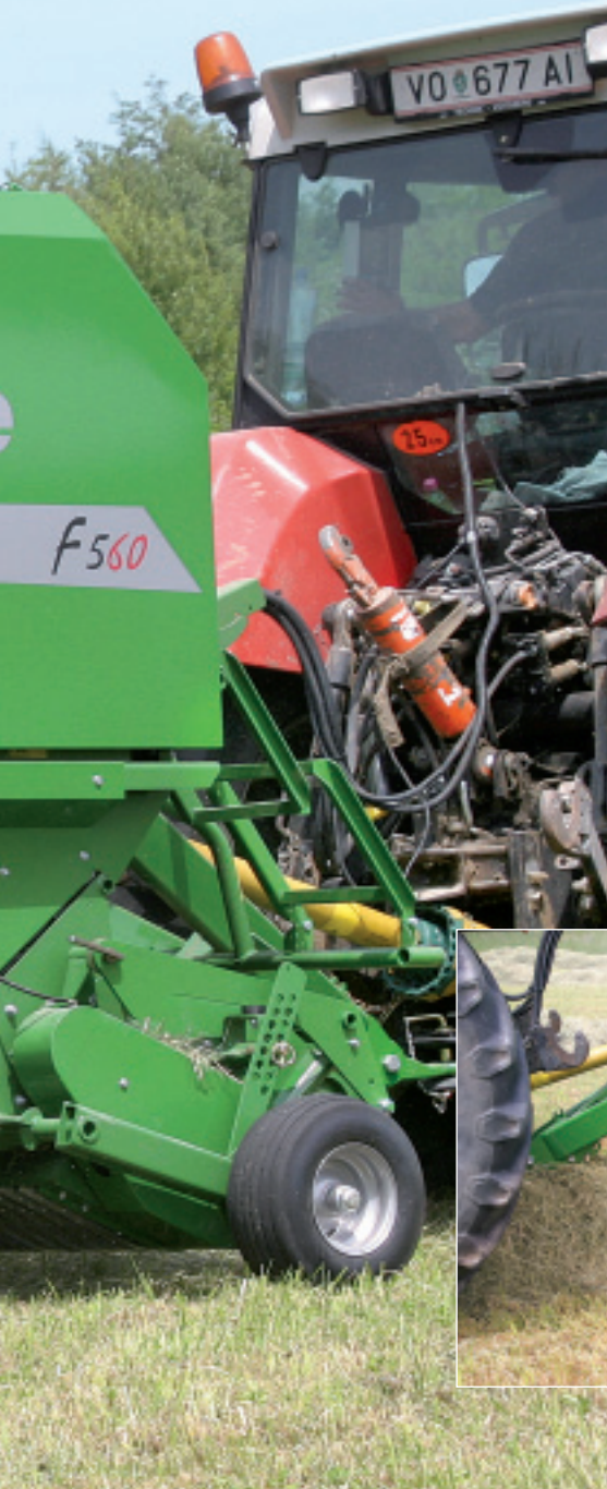
Die breite Pick-up mit 70 mm Zinkenabstand nimmt auch kurzes Futter sauber auf. Der Rollenniederhalter ist optional.
