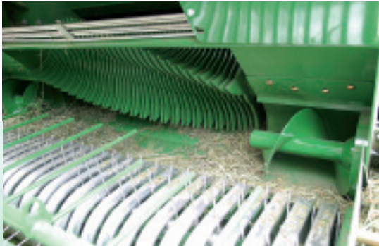
Leistungsstarker Rotor mit langen, spiralförmig angeordneten Rotorfingern und seitlichen Zuführschnecken.
