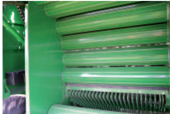
▲ 18 Presswalzen mit Längsrippen lassen auch beim Pressen von Stroh den Ballen sicher rotieren.
